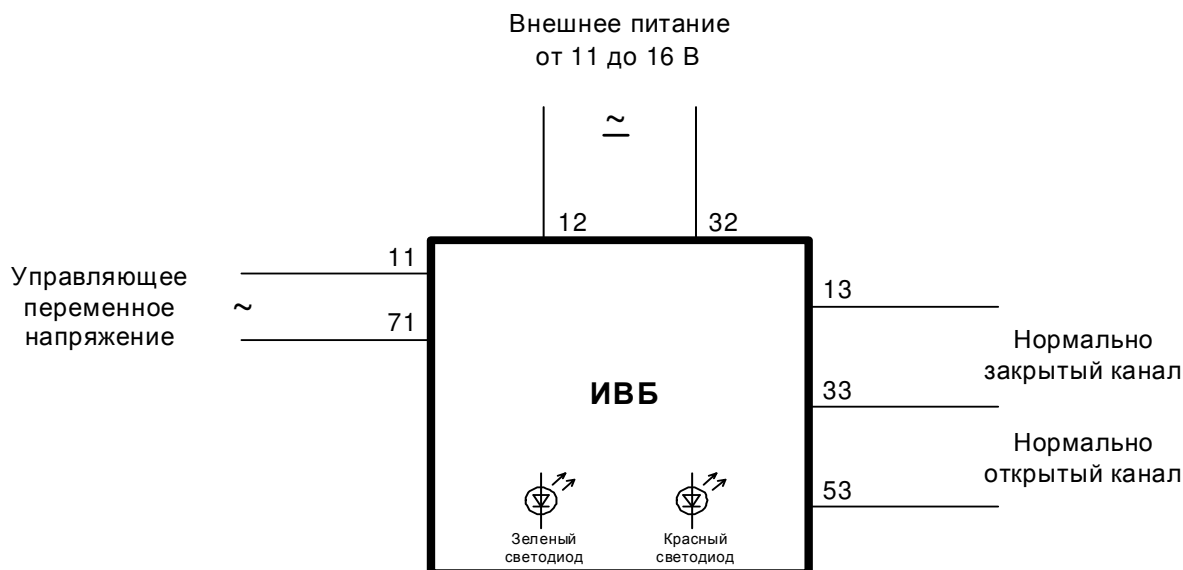
Рисунок 1 – Схема внешних подключений реле ИВБ
